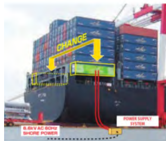
停泊中船舶への陸上電力供給
