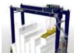
出典：三井E&SマシナリーHP 水素燃料電池搭載型RTG(技術開発中)
